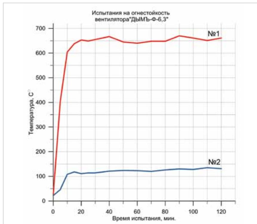
Рис. 1. Кривая № 1, температура газовой смеси на входе в вентилятор.
